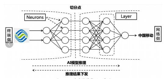
图 6.3-1: 端边协作推理示意图
