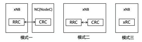
NC(NodeC): Computing Node CRC: Computing Resource Control 图 4.2-3: AI 计算和通信在控制面上融合的三种模式
