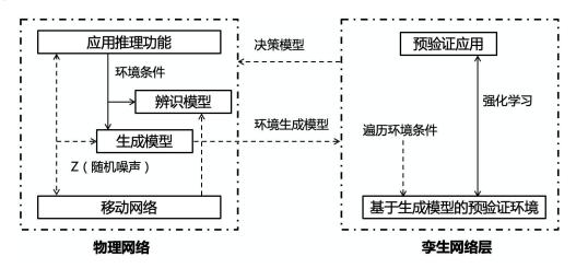
图 6.4-1: 基于网络数字孪生的模型性能预验证流程
