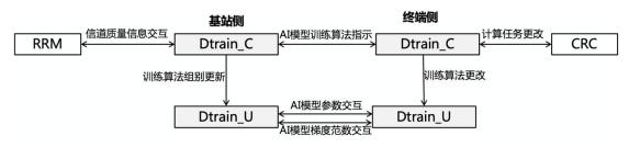
图 6.2-2: 多种学习算法动态转换机制的功能交互
