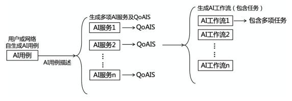
图 5.2-2: AI 用例、AI 服务、AI 工作流和 AI 任务之间的逻辑关系
