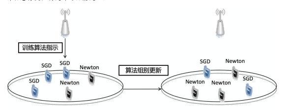
图 6.2-1: 多种学习算法动态转换原理示意图
